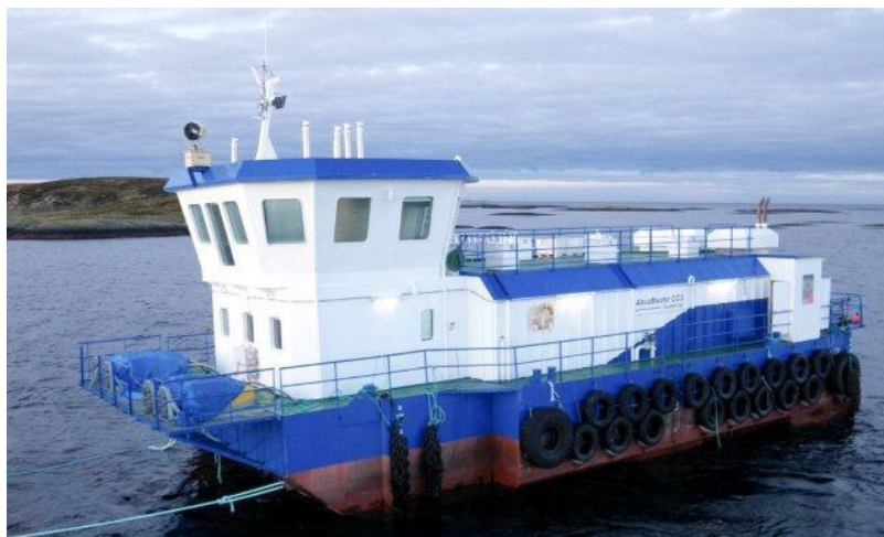
Mynd 7. Dæmigerður fóðurprammi, með stjórnstöð og starfsmannaaðstöðu. Fyrirhugað er að staðsetja slíkan pramma innan eldissvæðis, við kvíaþyrpingu. Frá fóðurpramma er fóðrinu dælt út í eldiskvíar með háþrýstilofti gegnum plaströr.
